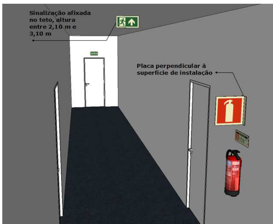
Imagem 08 – Sinalização básica de rota de fuga e de extintor de incêndio instalada em corredor.
