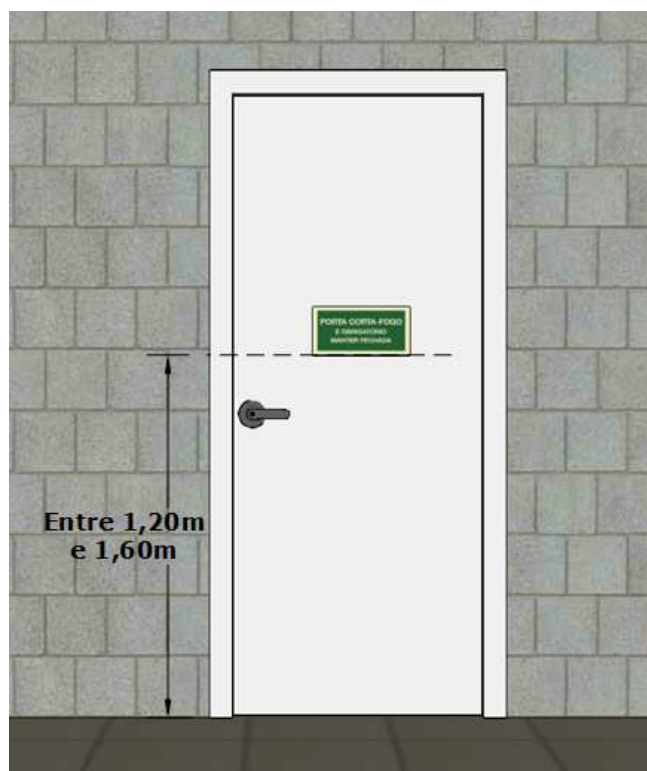
Imagem 07 – Sinalização de porta corta-fogo mantida fechada, porém destrancada. (ver sinalizações de códigos S12, S14 e S19)
