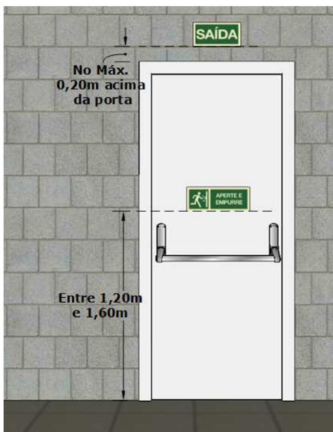
Imagem 06 – Sinalização de porta de saída de emergência e sinalização de abertura da porta por barra antipânico. (ver sinalizações de códigos S12, S14 e S18)
