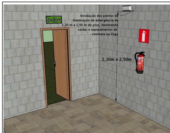
Figura 12 - Instalação dos pontos de iluminação de emergência
