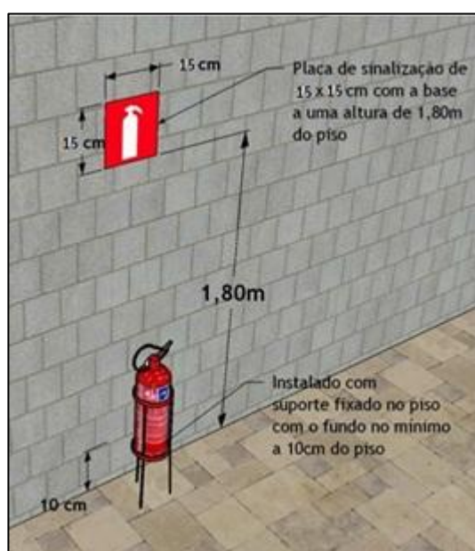
Instalação no piso
